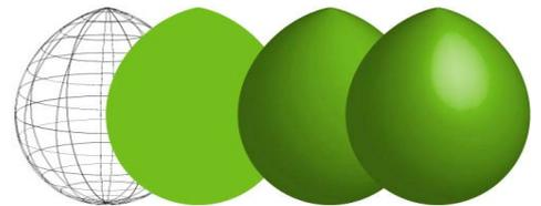
**Beleuchtungsmodelle** = physikalische Simulation der Lichtverhältnisse und -ausbreitung und deren Auswirkung auf das Erscheinen von Oberflächen.
