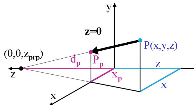
Daraus folgt  $x_p : x = d_p : (d_p - z)$  oder  $x_p = x \cdot d_p / (d_p - z)$  und analog  $y_p : y = d_p : (d_p - z)$  oder  $y_p = y \cdot d_p / (d_p - z)$  und selbstverständlich  $z_p = 0$ .
