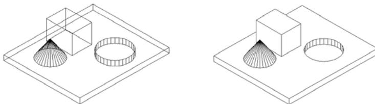
**Korrekte Sichtbarkeit** = Oberflächenelemente (Kanten, Polygone), die von anderen Oberflächen verdeckt werden, werden nicht gezeichnet, sodass man nur sichtbare Bereiche sieht.
